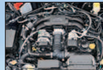
Vierzylinder-Boxer mit zwei Liter Hubraum ohne Zwangsbeatmung
